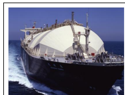
■泉州丸（提供:MOL LNG） 全長 283.0m、幅 44.8m、総トン数 103,022t、 LNG 積載容量 125,570 m 3 。
